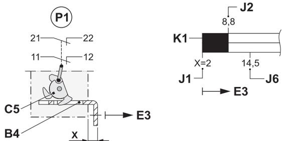
P1 Prinzipdarstellung der Schaltmechanik zur Realisierung der Zwangsöffnung mit Betätiger, Schaltwalze und Stößel
